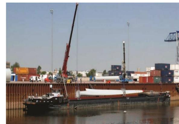
Figure 84 : Acheminement d'une pale par bateau (source : Valorem, 2015)
