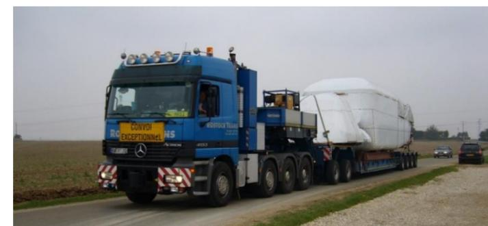
Figure 85: Transport de la nacelle (source : Valorem, 2015)
